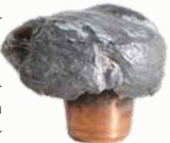
Kontrolliertes Aufpilzen durch Verbundtechnologie.
